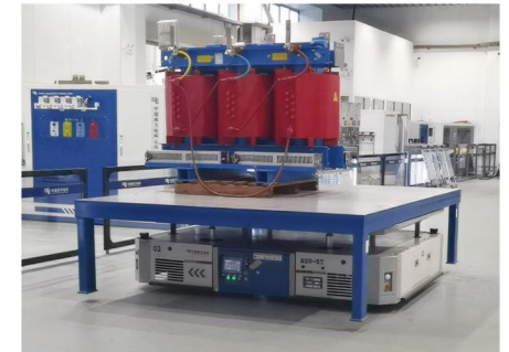
5吨激光升降称重AGV——南方电网 5 tons laser navigation AGV
